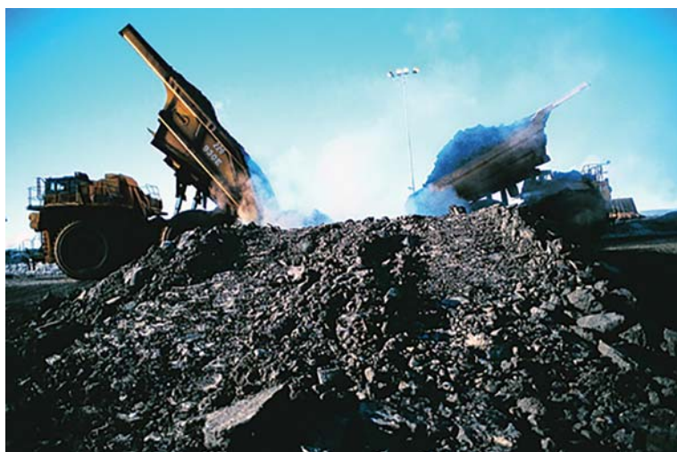
Tại mỏ Suncor Energy Inc., xe tải vận chuyển 500.000 tấn cát dầu/ngày tới nhà máy chuẩn bị quặng.
