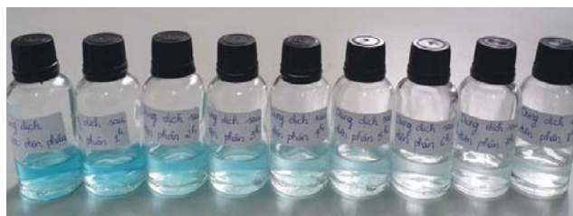
Hình 11. Dung dịch Cu sau 1 - 8 giờ điện phân
